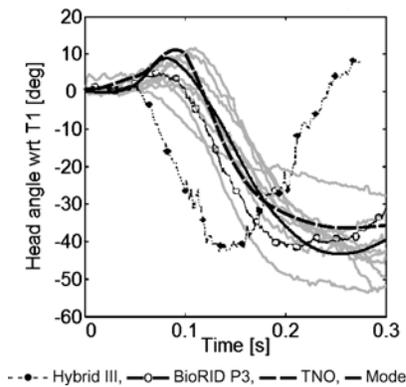
**Figure 4** Head angles wrt T1 (--- Hybrid III, BioRID P3, TNO, model).
